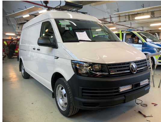
8. På bilden ovan är stötfångaren återmonterad och extraljus är på plats.
