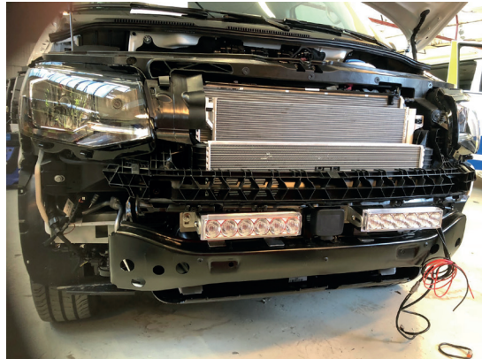
7. På bilden ovan är hela stötfångaren demonterad, och extraljusen är monterade.
